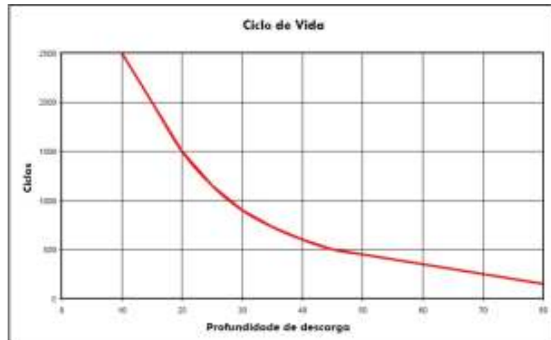
Figura 24: Ciclo de Vida para Bateria Freedom DF 4001 Fonte: Catálogo Técnico da Bateria Estacionária Freedom
